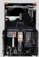
**TESTO 380****Modelo 0632 3800****MEDIDOR DE PARTÍCULAS FINAS**
